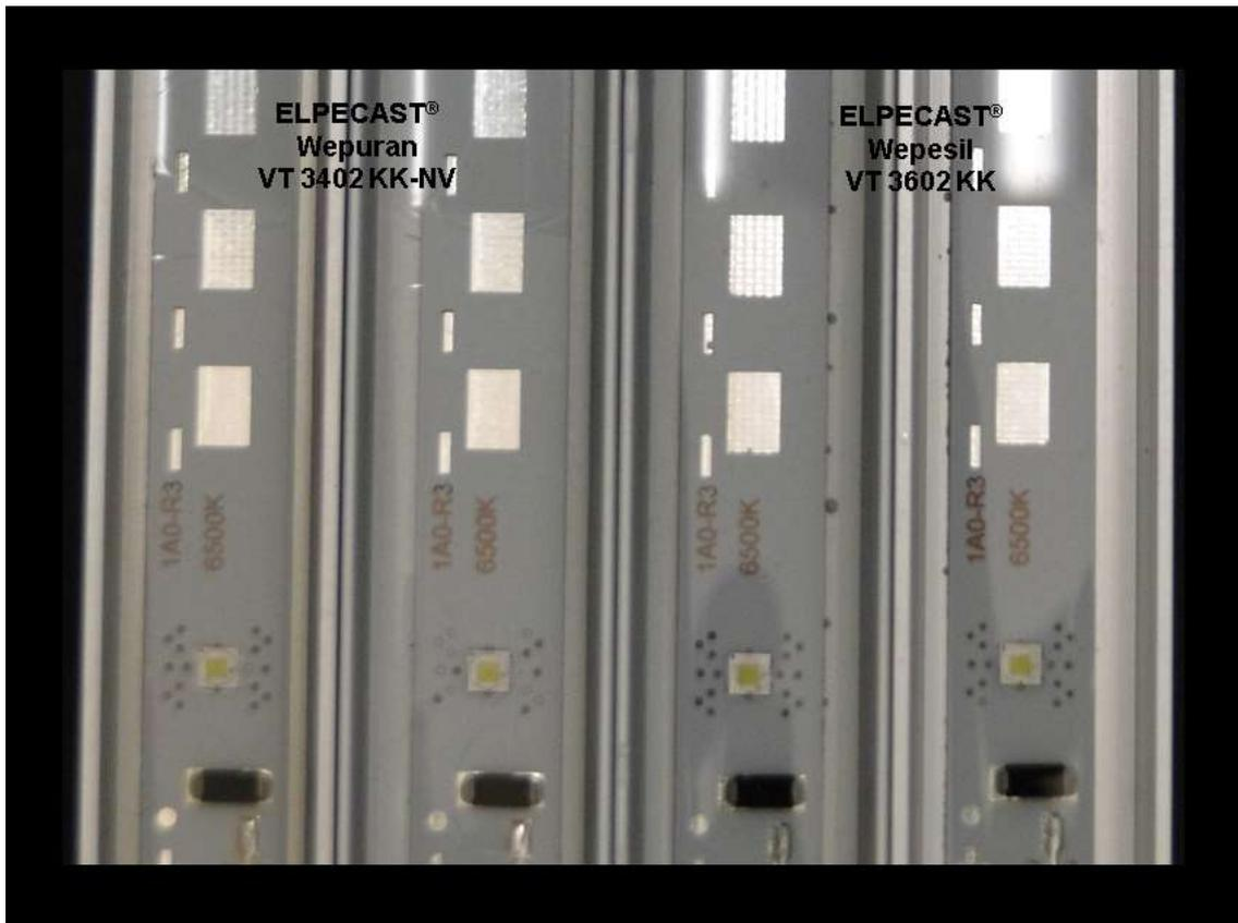
Abbildung 6: ELPECAST® Vergussmassen nach 85/85-Test
