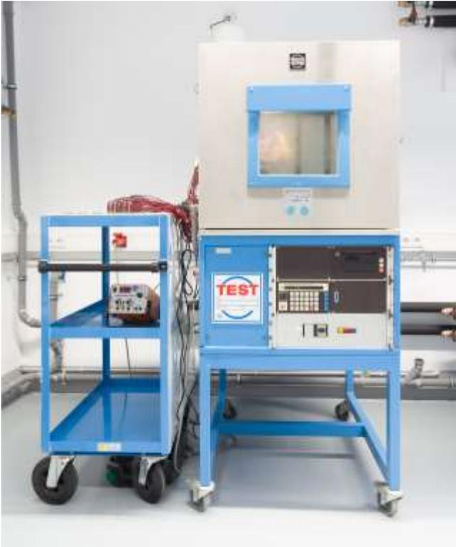
Abbildung 4: Klimakammer für den 85/85-Test
