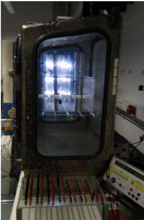
**Abbildung 1: Klimakammer für Schwitzwasser-Test**
