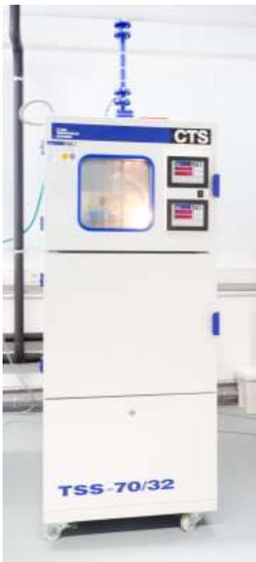
Abbildung 7: Klimakammer für Temperaturwechseltests (TWT)
