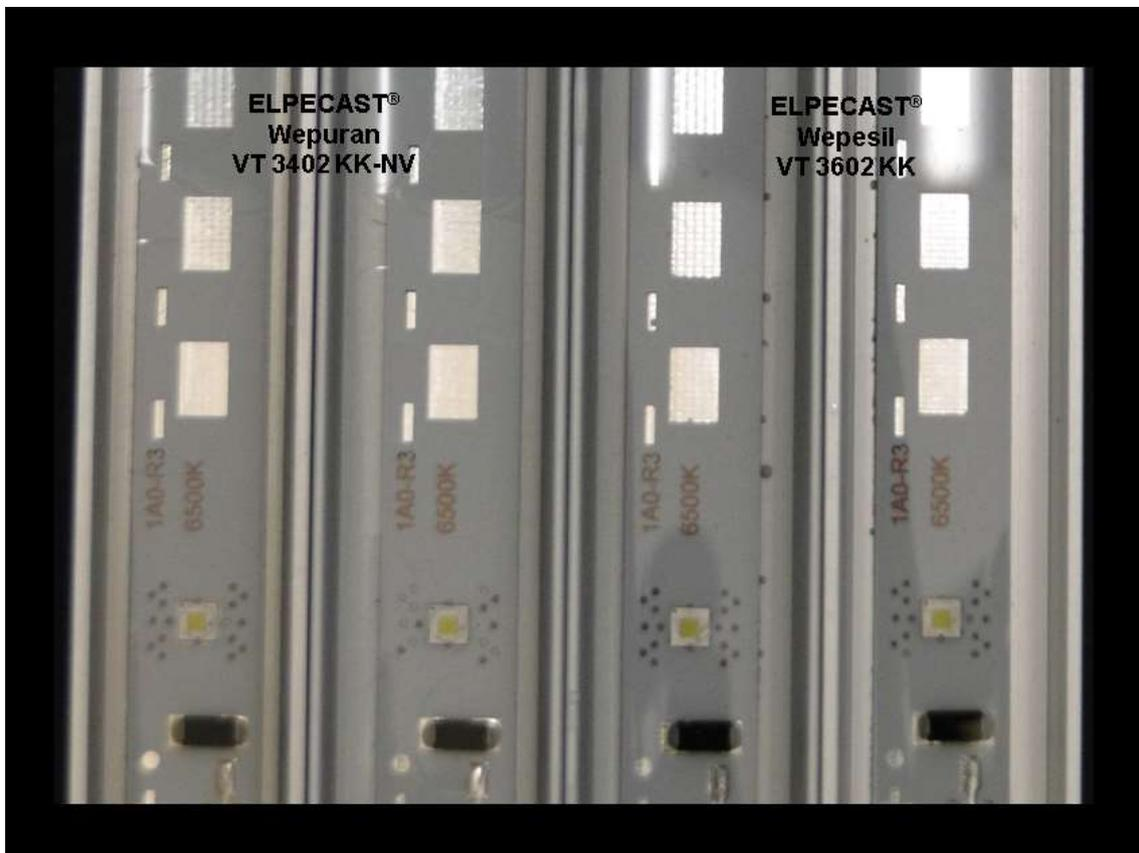
Abbildung 3: ELPECAST® Vergussmassen nach Schwitzwassertest
