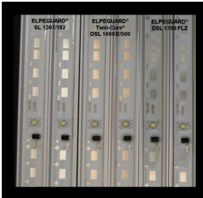
Abbildung 5: ELPEGUARD® Schutzlacke nach 85/85-Test
