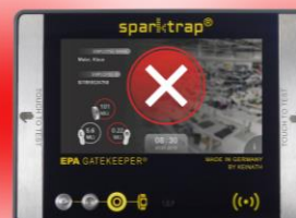
Rote Signalisierung bei „schlecht“ Messung
