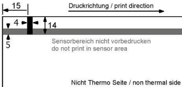
Die Steuermarken müssen mit einer Infrarot absorbierenden Farbe im Bereich 910 – 950 nm mit einer optischen Dichte von min. 1.0 bedruckt werden.
