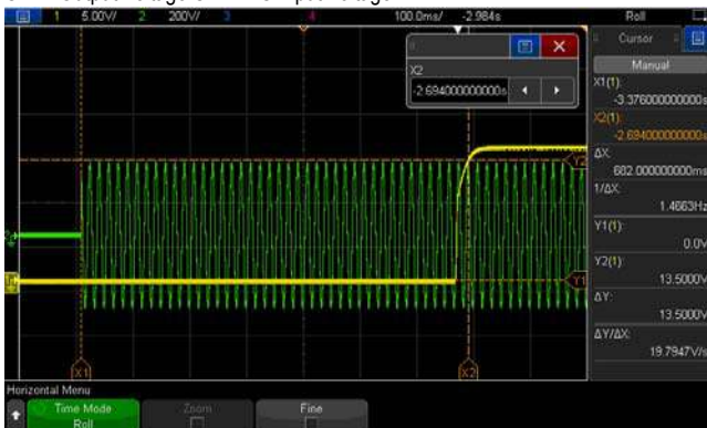
CH1 : Output Voltage CH2 : AC Input Voltage
