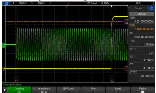
CH1 : Output Voltage CH2 : AC Input Voltage
