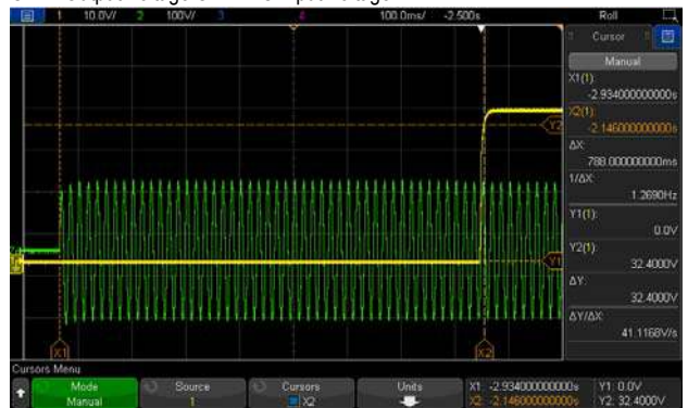
CH1 : Output Voltage CH2 : AC Input Voltage
