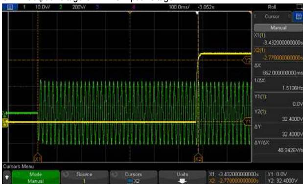
CH1 : Output Voltage CH2 : AC Input Voltage
